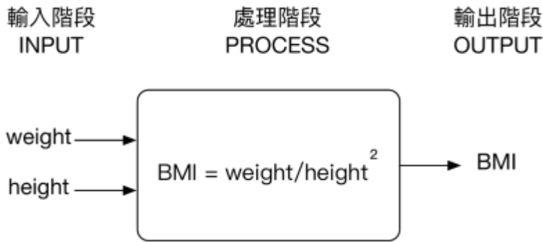
Fig. 2: BMI計算程式的IPO模型圖。
