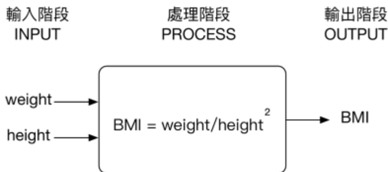
Fig. 2: BMI計算程式的IPO模型圖。
