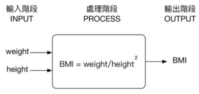
Fig. 2: BMI計算程式的IPO模型圖。
