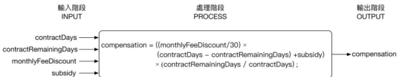
Fig. 8: 手機門號違約金計算程式的IPO模型
