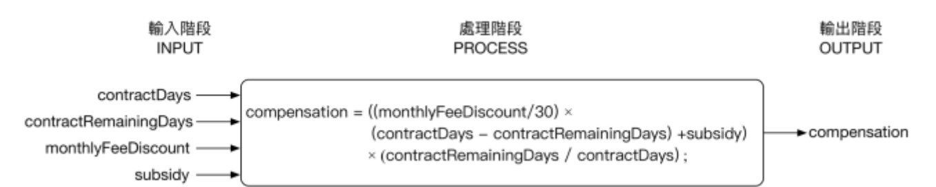
Fig. 8: 手機門號違約金計算程式的IPO模型
