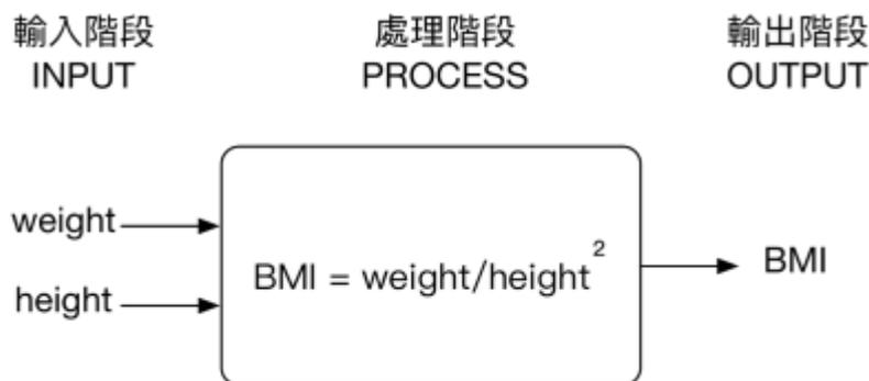
Fig. 2: BMI計算程式的IPO模型圖。
